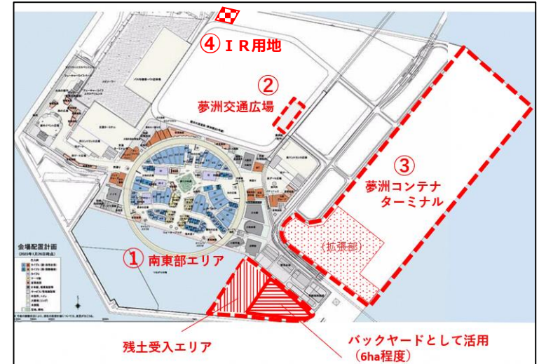
バックヤード用地活用箇所
