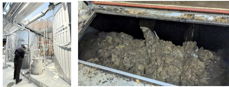
図 3-2-42 日本館のバイオガス装置 (左)、メインストックヤード内のコンポスト機 (右) 出典：日本館 公式 X ( https://x.com/japanpavilion_j/status/1942524100779663459/photo/2 )
