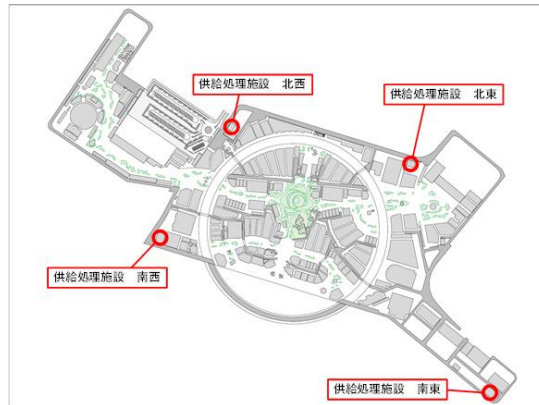
図 3-2-4 空調用冷水の供給処理施設の位置
