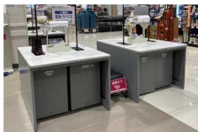
・サッカー台 (上端高さ:720mm、下端高さ:680mm)
