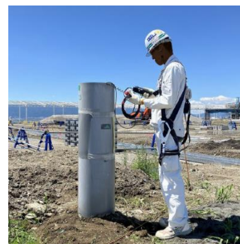
〔図6:ガス抜き管周辺の測定箇所(右図は再測定箇所)〕 〔図7:ガス抜き管周辺の測定状況〕
